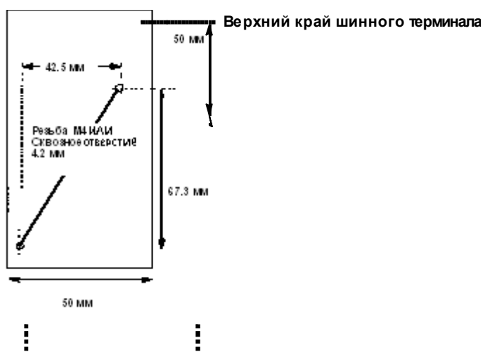
Рисунок 4-31 Схема расположения монтажных отверстий для шинного терминала.
